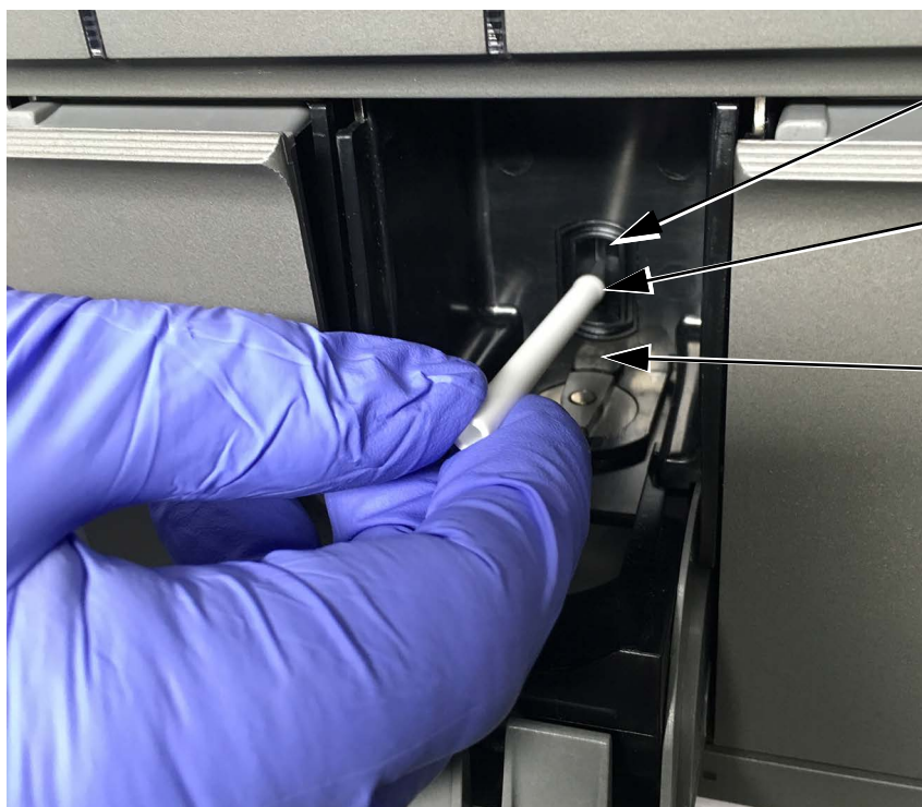
Εικόνα 2-2. Εισαγωγή βούρτσας καθαρισμού στη σχισμή του I-CORE
