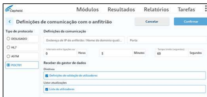
Figura 41. Ecrã Comunicação com o anfitrião a mostrar a Lista de utilizadores seleccionada
