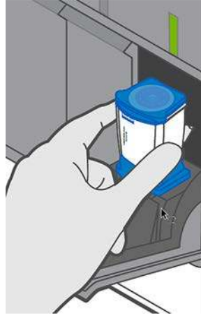
Figura 21. Colocação do cartucho
