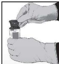
5 Con una pipeta de transferencia (no suministrada) limpia, transfiera todo el contenido del frasco de reactivo de elución a la cámara de muestras del cartucho.
