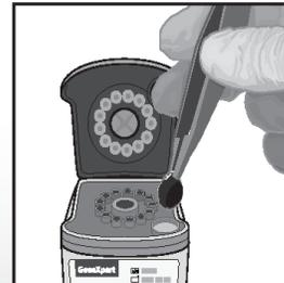
5 Empuje con las pinzas hacia abajo la mancha de sangre seca en papel hasta que alcance la parte inferior de la cámara.
