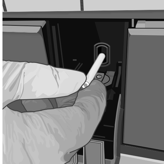
Ilustracja 72. Wprowadzanie szczotki czyszczącej do szczeliny modułu I-CORE
