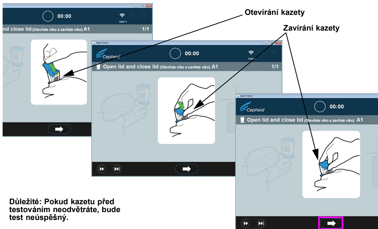
Obrázek 2-16. Odvětrání kazety otevřením a zavřením víka kazety – animovaná obrazovka
