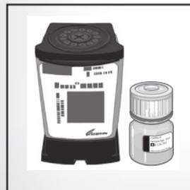
2 Avec le couvercle du flacon de réactif échantillon fermé, mélanger l'échantillon au vortex pendant 10 secondes.
