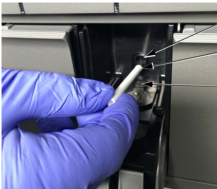
Figura 2-2. Inserção da escova de limpeza na ranhura do I-CORE
