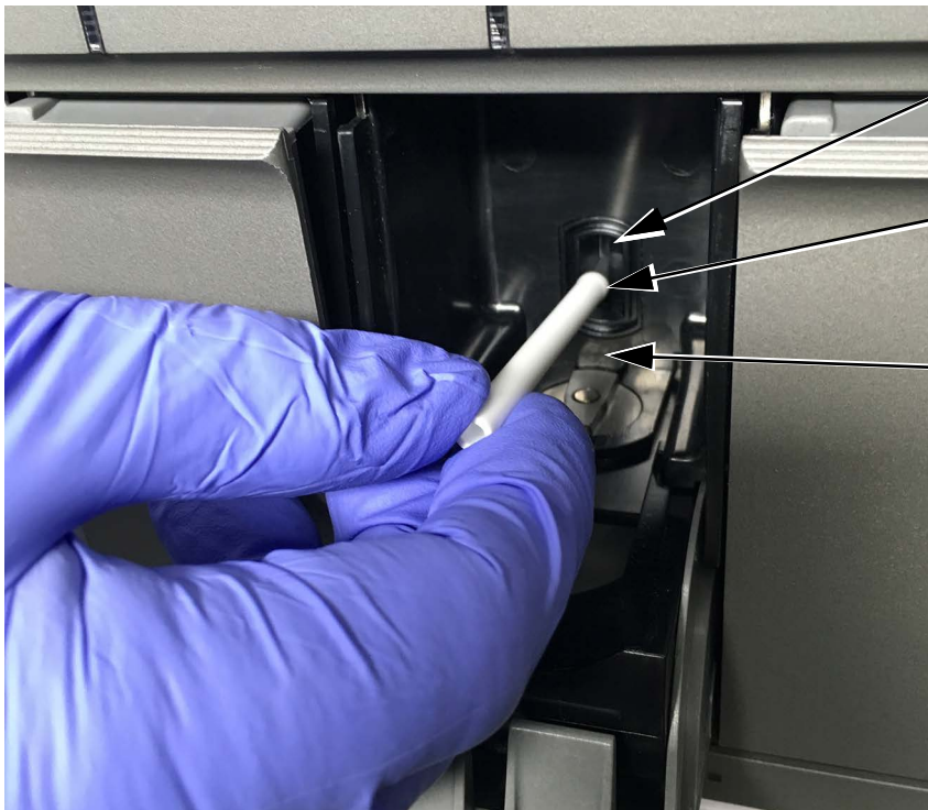
図 2-2. I-COREスリットへの清掃ブラシの挿入
