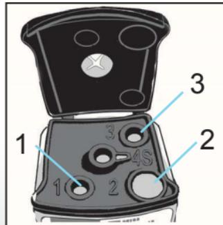
4 140 µl des Lysereagens in Kammer 4S pipettieren und anschließend 140 µl der Probe in Kammer 4S pipettieren.
