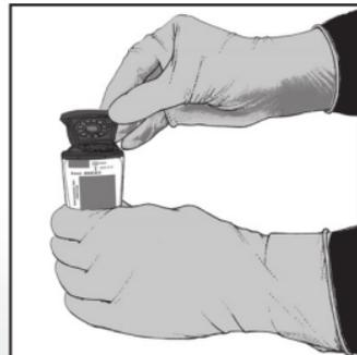
3 Die Ampullen öffnen und anschließend Ampulle 1 in Öffnung 1, Ampulle 2 in Öffnung 2 und Ampulle 3 in Öffnung 3 geben.
