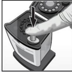
3. Placer la Minivette entièrement dans la chambre à échantillon de la cartouche et appuyer doucement sur le piston pour distribuer l'échantillon de sang total.
