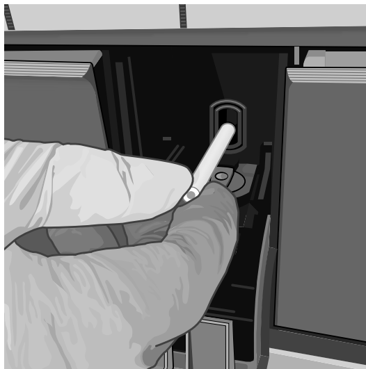
Figur 72. Införing av rengöringsborsten i I-CORE-modulslitsen
