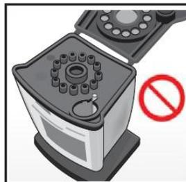
Posizionamento errato del tampone. L'estremità del tampone è rimasta incastrata nella scanalatura dell'apertura per il campione.
