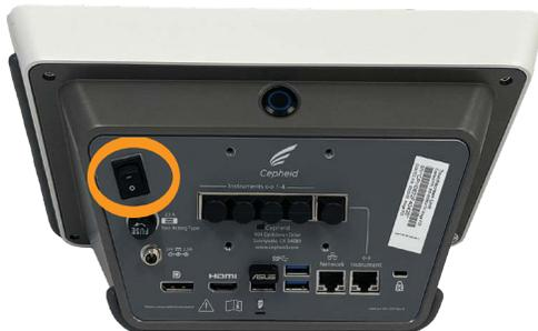
3. Appuyer sur l'interrupteur d'alimentation à l'arrière de l'instrument pour le mettre en position **ARRÊT (OFF)**.
