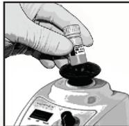
**6** Utilizando uma pipeta de transferência (não fornecida), transfira todo o conteúdo do frasco para a câmara de amostra do cartucho.
