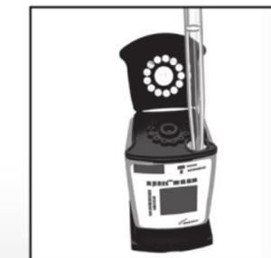
7 Bien fermer le couvercle. Démarrer le test dans le délai précisé dans la notice.
