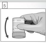
Capovolgere delicatamente la provetta di trasporto 8-10 volte per miscelare Oppure miscelare con un miscelatore vortex a velocità media per 5 s
