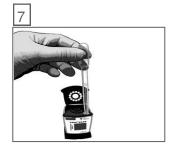
Svuotare lentamente la pipetta nella camera per il campione della cartuccia
