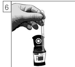
Esvazie lentamente a pipeta para a câmara da amostra do cartucho
