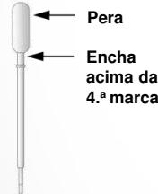
\*Pipeta de transferência do ensaio HBV VL
