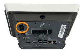
3. Pulse el interruptor en la parte posterior del instrumento en la posición de apagado. La luz azul del panel delantero se apagará.
