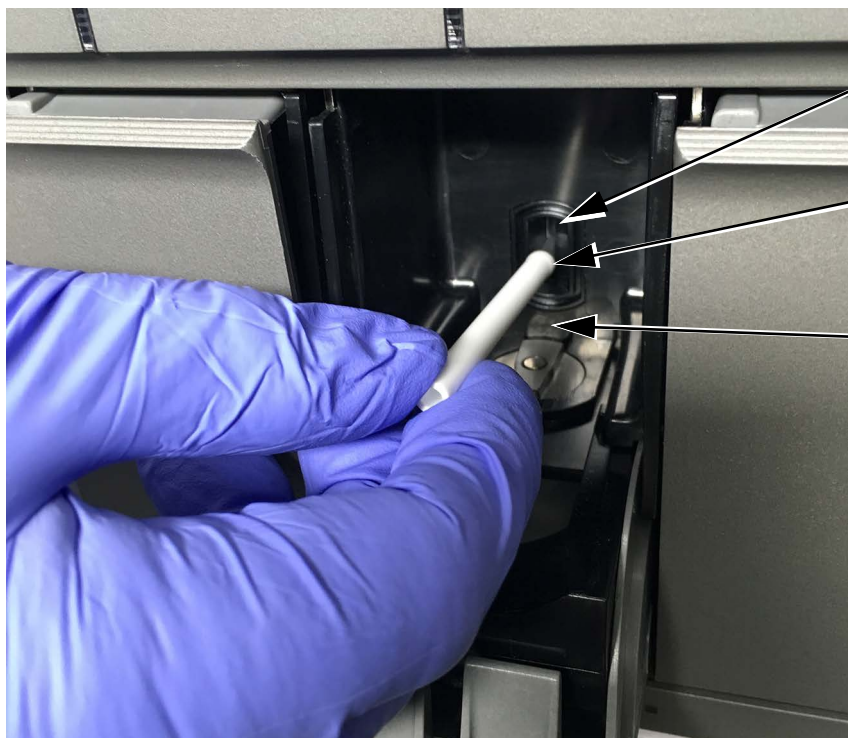
Pav. 2-2. Valymo šepetėlio įdėjimas į „I-CORE“ plyšį
