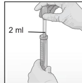
6 Coloque a amostra lentamente na câmara de amostras do cartucho.
