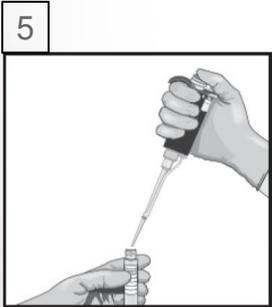
Utilizando uma pipeta volumétrica com uma ponta resistente a aerossóis, aspire 50 µl da amostra.
