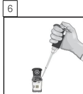
Transfira a amostra para a parede inferior da câmara "S" do cartucho.
