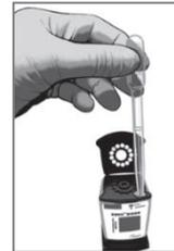
Die Pipette langsam in die Probenkammer der Kartusche entleeren.
