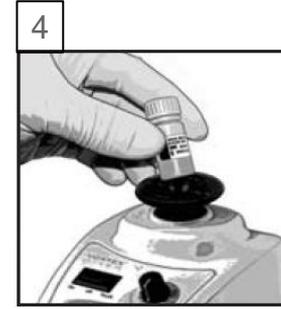
Das Fläschchen mit Probenreagenz wieder verschließen und 10 Sekunden lang vortexen.
