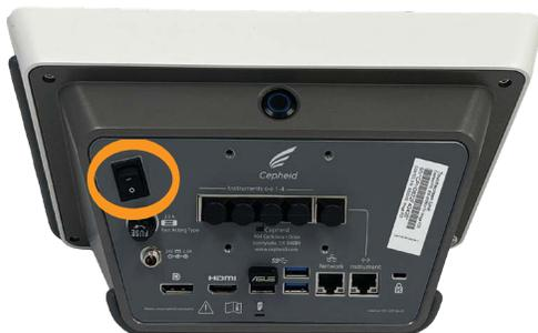
3. Premere l'interruttore sul retro dello strumento portandolo sulla posizione di spegnimento **OFF**. La spia blu sul pannello anteriore si spegne.
