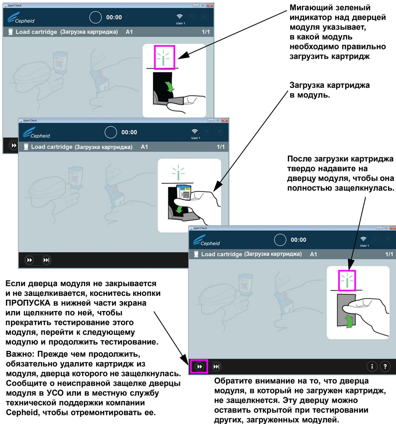
Рисунок 2-17. Загрузка картриджа в модуль
