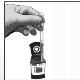
**7** Coloque la tapa en el cartucho Xpert. Inicie la prueba dentro del período especificado en el prospecto.
