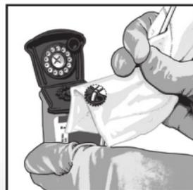
**3** Assicurarsi che il tampone sia posizionato correttamente nella cartuccia, che l'estremità del tampone non si trovi nella scanalatura dell'apertura della camera per il campione e che non impedisca la chiusura del coperchio.
