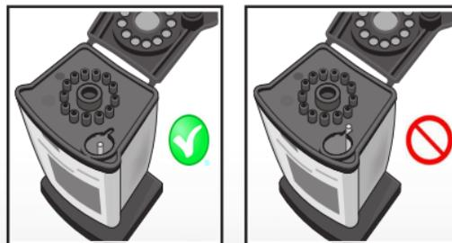
**4** Se il tampone è incastrato nella scanalatura, utilizzare un panno/una garza senza lanugine o l'estremità avanzata dallo spezzamento del tampone per toglierlo dalla scanalatura, per ridurre al minimo il rischio di contaminazione.
