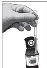
Esvazie lentamente a pipeta para a câmara da amostra do cartucho
