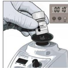
Agite a amostra num agitador de vórtex durante 10 segundos
