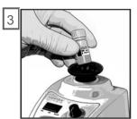
Coloque novamente a tampa no frasco de reagente de amostra e misture durante 10 segundos.
