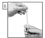
Aspire a totalidade do frasco de reagente de amostra com uma pipeta de transferência descartável.
