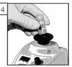
Coloque novamente a tampa no frasco de reagente de amostra e misture durante 10 segundos.
