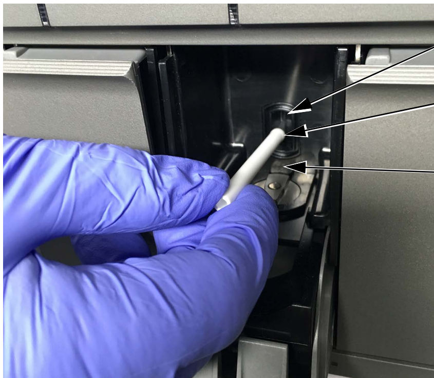
Abbildung 2-2. Einführen des Reinigungspinsels in den Schlitz des I-CORE-Moduls
