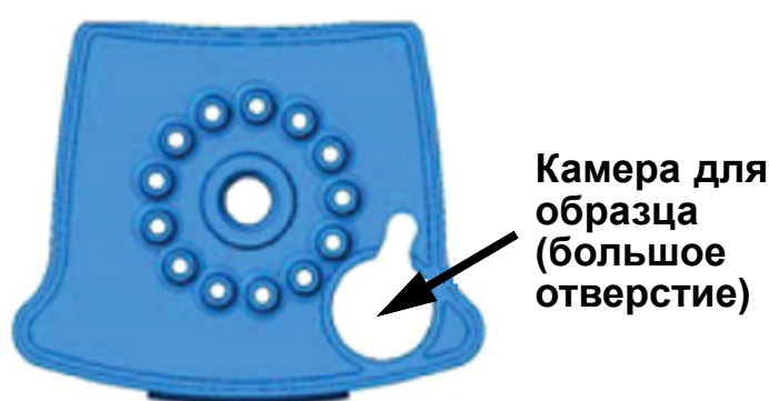
Рисунок 1. Картридж Хpert GBS (вид сверху)
