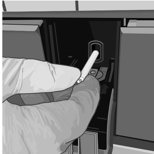
Figura 72. Introducción del cepillo de limpieza en la ranura del módulo I-CORE
