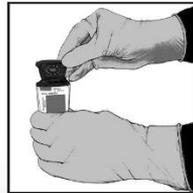
4 Utilizzando una pipetta pulita da 300 µL (fornita), trasferire 300 µL (un'aspirazione) di campione nell'apertura della cartuccia.
