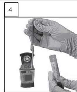
Utilizzando una pipetta pulita da 300  $\mu$ L (fornita), trasferire 300  $\mu$ L (un'aspirazione) di campione nella cartuccia.
