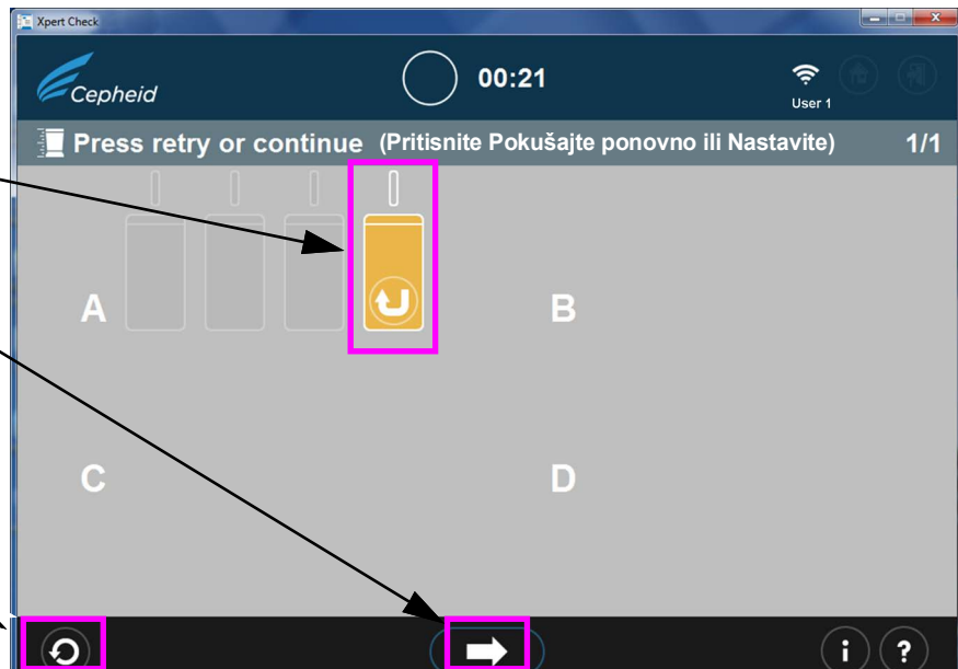
Slika 2-20. Zaslون Dovršetak testa – primjer neuspješne provjere modula
