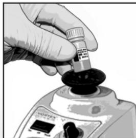
**6** Con una pipetta di trasferimento (non in dotazione), trasferire l'intero contenuto del flaconcino alla camera della cartuccia riservata al campione.
