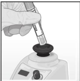
**3** Con una pipetta di trasferimento (non in dotazione), trasferire 300 µl di campione liquido nel flaconcino del reagente di eluizione.
