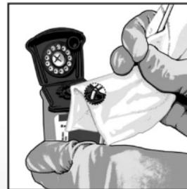
**3** Fermer le couvercle de la cartouche. Démarrer le test dans le délai précisé.
