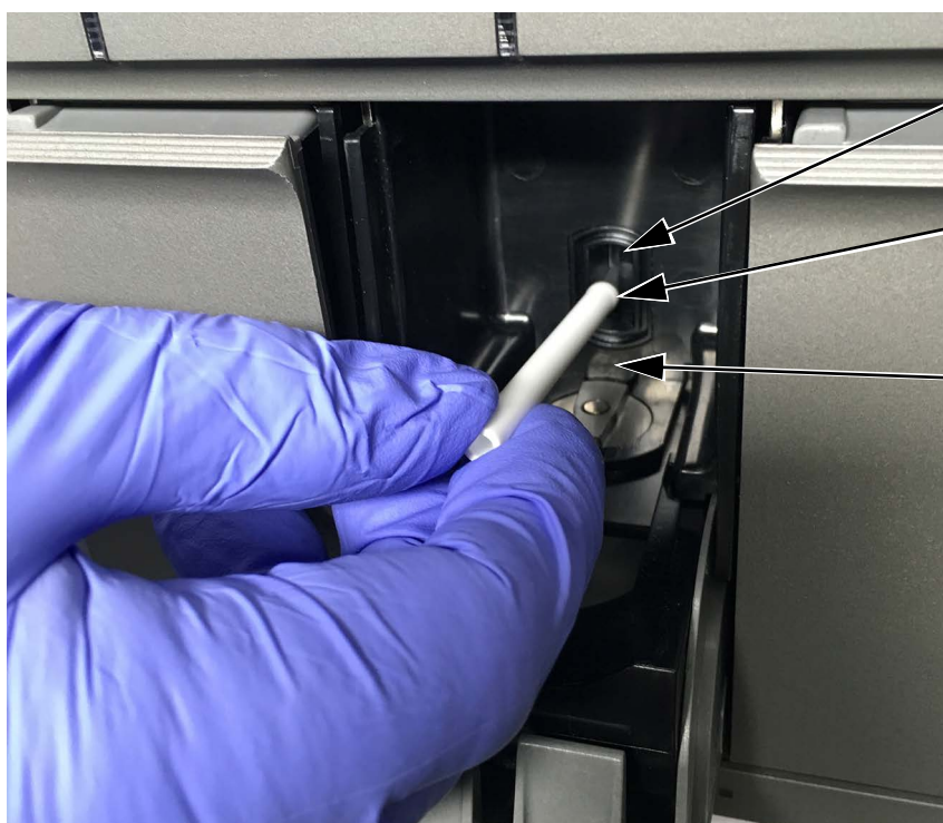
Слика 2-2. Вметнување на четката за чистење во отворот на I-CORE
