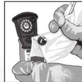
**3** Den Kartuschendeckel schließen. Den Test innerhalb des angegebenen Zeitrahmens beginnen.
