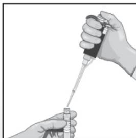
6 Déposer l'échantillon sur la paroi inférieure de la chambre « S » de la cartouche.
