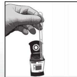
7 Den Deckel der Xpert Kartusche schließen. Den Test innerhalb des in der Packungsbeilage angegebenen Zeitrahmens beginnen.
