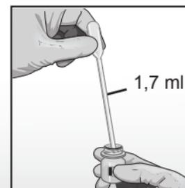
6 Die Pipette langsam in die Probenkammer entleeren.
